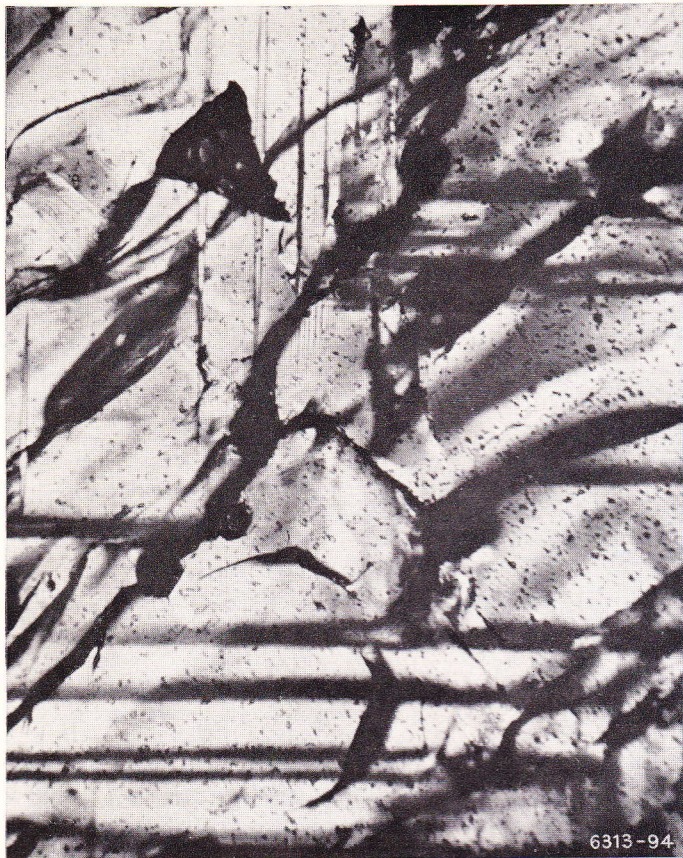
Abb. 8 Leucit ist ein pseudokubischer Kristall, der aus feinsten Lamellen aufgebaut ist. Im polarisierten Licht treten diese deutlich hervor.
