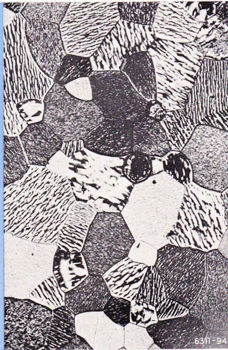
Abb. 5 Wachstum der Oxydhäute nach 5 min bei 350 °C
