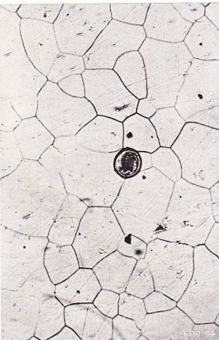
Abb. 4 Grobkristalliner Tantal bei 20 °C Obj. 10X/0.18 mit ORTHOMAT Aufn.: R. Anschütz, Wiss. Abt. LEITZ-Werke.
