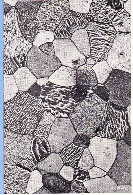
Abb. 6 Wachstum der Oxydhäute nach 10 min bei 350 °C
