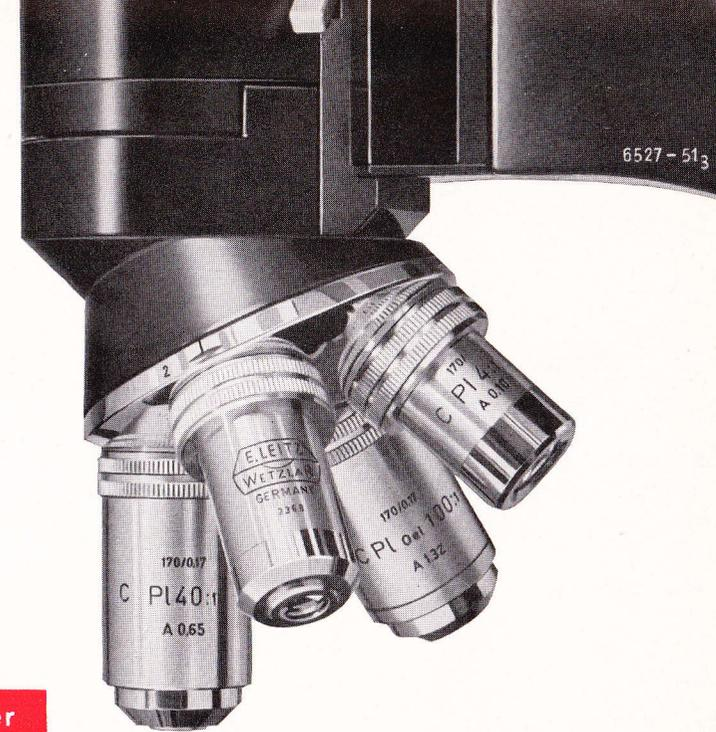
Der staubdichte Objektivrevolver an Trägerstück ist abnehmbar (Kennzeichen der Grundausrüstung: Erste und zweite Ziffer 10-4). Die Zentrierung der Objektive bleibt beim Revolverwechsel erhalten. Es ist somit ohne weiteres möglich, einen zweiten zentrierten Revolver, z. B. mit abgestimmten Phasenkontrast-Objektiven, wechselweise anzusetzen. Ebenso kann der Auflichtilluminator ULTROPÄK angesetzt werden (s. Seiten 30/31).
