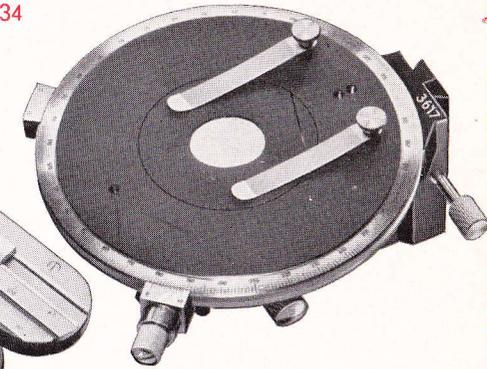
Der zentrierte Drehtisch mit Gradteilung wird nur in Verbindung mit der Sonderausführung ORTHOLUX-BIOPOL geliefert (siehe Ergänzungsdruckschrift)
